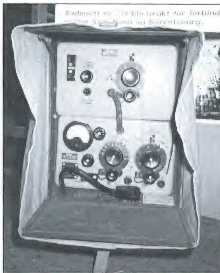
De Engelse no. 18 set. Een op de rug draagbare zend-ontvanginstallatie die tijdens de Tweede Wereldoorlog door het Britse leger veelvuldig werd gebruikt. Het bovenste deel is de ontvanger en het onderste deel is de zender. Onder het zenderchassis komt de voedingsbatterij voor 3 Volt gloeispanning en 150 Volt anodespanning. Op Spitsbergen is dit apparaat gebruikt voor de verbinding met het noordelijk gelegen Barendsburg.
